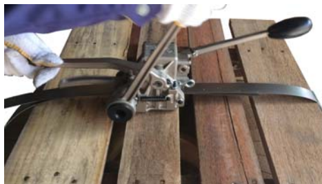
② 結束機の引き締め作業
