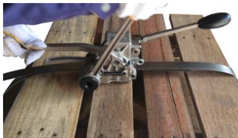
② 結束機の引き締め作業
