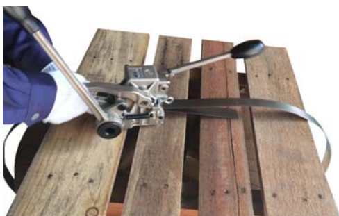
① 帯鉄へ結束機をのセット 直線部分が20～30cm必要です
