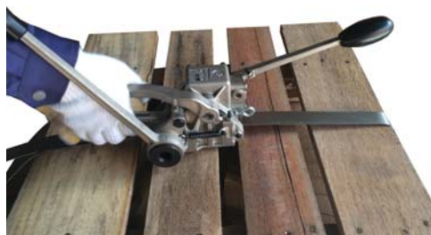
⑤ 結束機の取り外し
