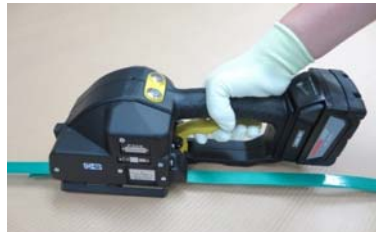
⑥溶着完了 LEDがグリーンになってから取り外します
