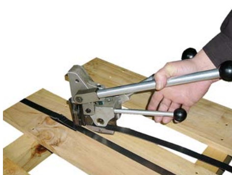
ワンタッチで結束機を取り外します
