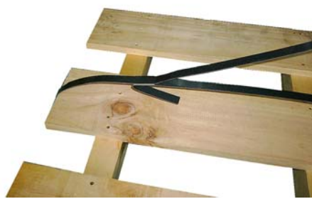
帯鉄を梱包物に巻き先端はシールを通し折り曲げます
