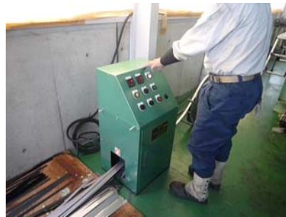
操作パネルで設定&切断スタート
