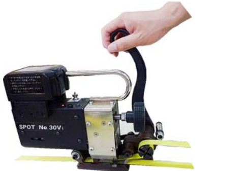
③引き締めハンドルを操作しドラムにバンドを巻き付け引き締めます
