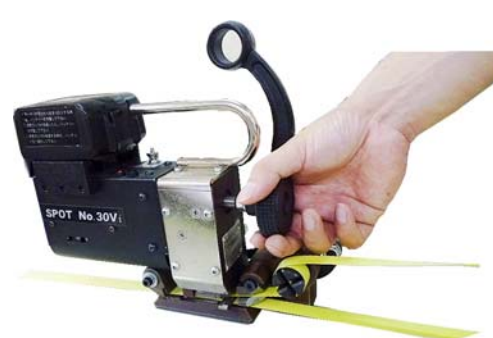
④溶着ノブを回転させ溶着&切断作業
